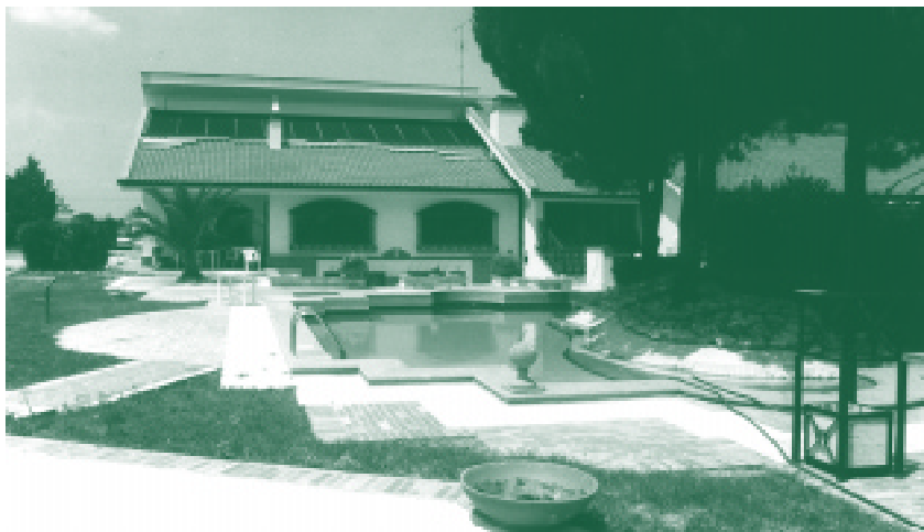
Piscina scoperta riscaldata con il termosolare
